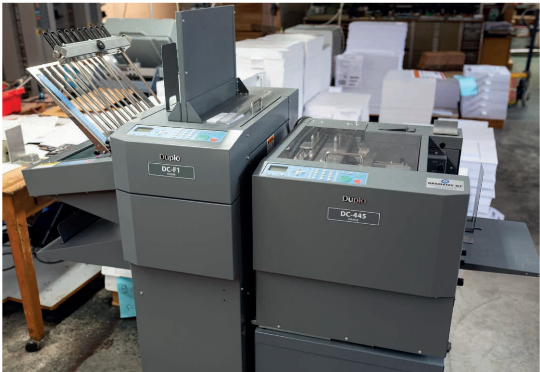
Paperin nuuttaamiseen ja taittamiseen tarkoitettu kone.
